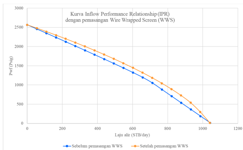
Gambar 7. IPR saat sebelum dan setelah pemasangan wire wrapped screen
