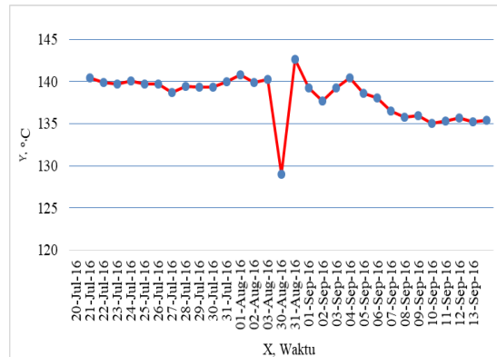
Gambar 3. Grafik Reaktor Temperatur inlet 20-R-101 A
